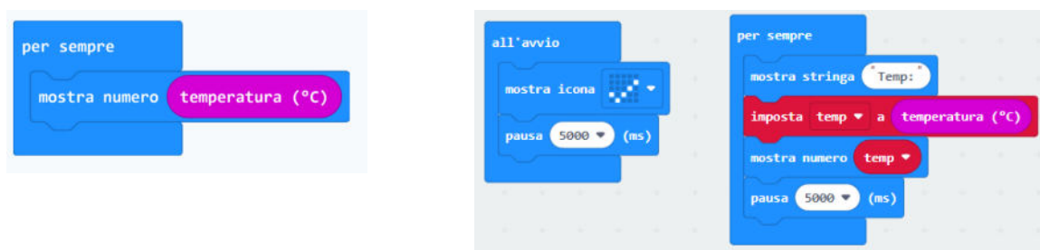
Figura 4. Esercizio sulla misura della temperatura interna con il sensore della scheda. Sulla sinistra il codice fornito dal docente, sulla destra il risultato dell'esercizio svolto.
