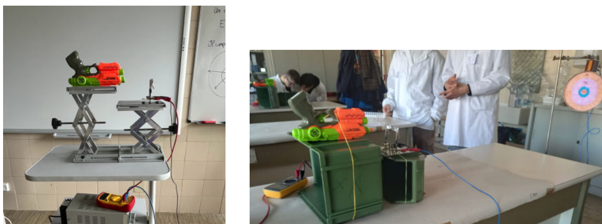
Figura 4. Montaggio del materiale per La scimmia e il cacciatore (pistola e bersaglio)
