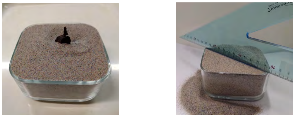
Figura 8. Immersione in polvere solida. Si mette a punto una procedura per riempire completamente il contenitore togliendo la sabbia in eccesso, come mostrato a destra. Si immerge completamente il meteorite come mostrato sinistra e poi si ripete la procedura per togliere la sabbia in eccesso che questa volta viene raccolta per misurarne la massa.
