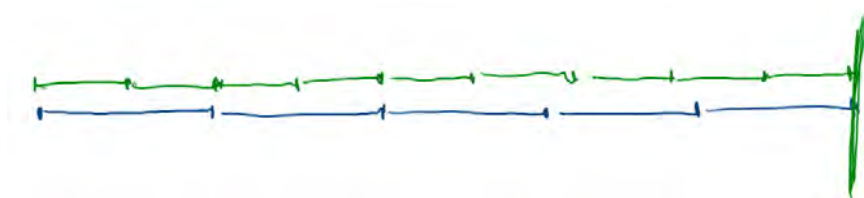
Figura 3. Il segmento di colore verde, in alto, indica le P volte in cui si ripetono i dentini della ruota; il segmento blu, in basso, le G volte in cui si ripetono i dentini dell'anello.
