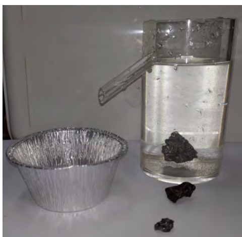
Figura 7. Il vaso di troppopieno durante la misura dei campioni più piccoli.
