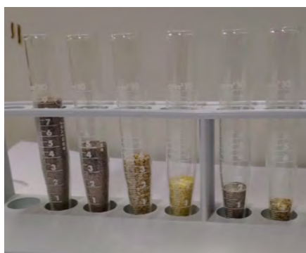
Figura 9. Altri materiali reperibili nella vita quotidiana che possono essere utilizzati per l'immersione in solidi. Da destra semi di sesamo, semi di quinoa, pasta da brodo e poi ancora sesamo e la sabbia fine utilizzata in precedenza in due misure diverse della densità.
